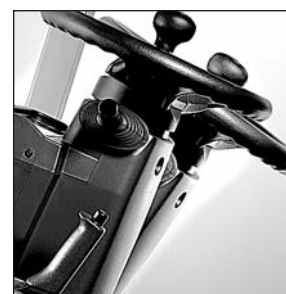
Piantone dello sterzo regolabile
