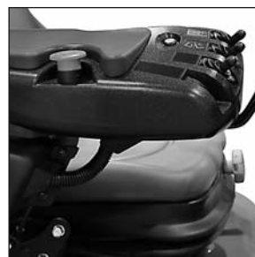
Comandi idraulici a sfioramento (opzionali)
